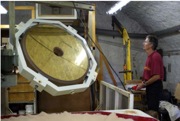
Le futur miroir principal du télescope Est de C2PU, dans la Poudrière de Roquevignon, l'atelier de réalisation et de contrôle optique de D. Vernet.
