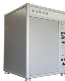
Nous avons intégré mardi dernier dans la salle des horloges à Calern un nouveau Maser à Hydrogène. Un Maser à hydrogène est une horloge qui est extrêmement stable sur des périodes de quelques heures. Cette horloge va notamment servir de référence de temps pour le projet T2L2.
