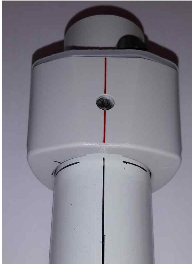
Photo 18 : Alignement de la tête intermédiaire sur le repère tracé sur le mât
