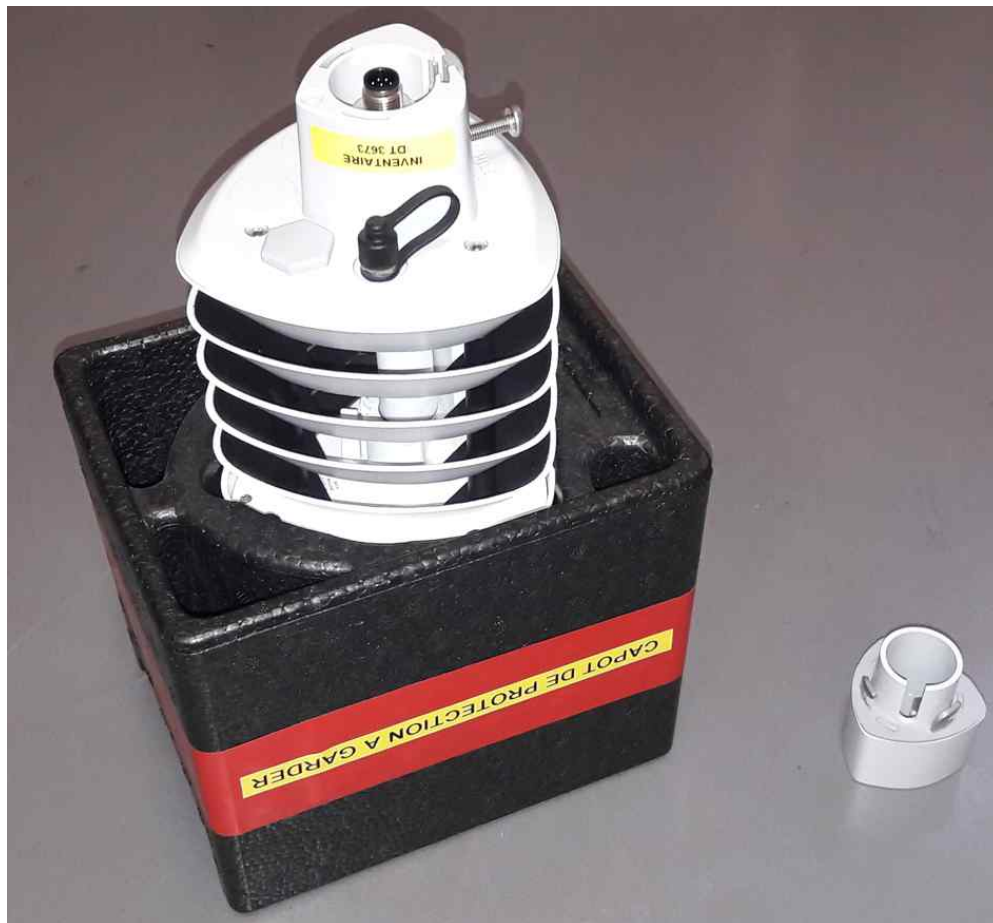
Photo 17 : A droite de la station WXT 536 capotée on voit la tête intermédiaire de support de mât
