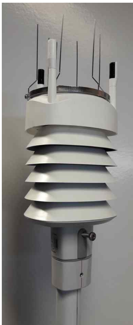
Photo 19 : Station fixée sur le mât au moyen de la tête intermédiaire
