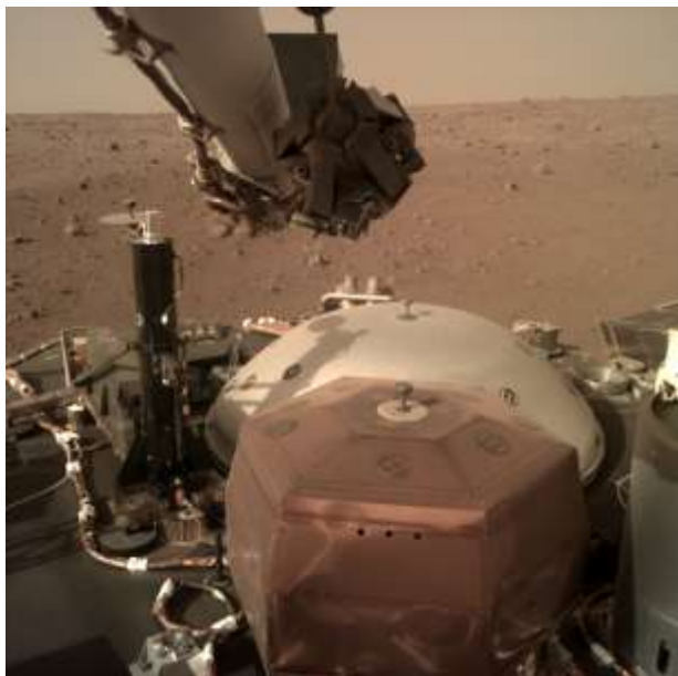
Photographie de la caméra IDC prise durant le sol 8, et montrant le sismomètre SEIS ainsi que le bouclier thermique et éolien WTS sur le pont de l'atterrisseur InSight. La surface martienne n'est plus qu'à un mètre de distance (© NASA/JPL).
